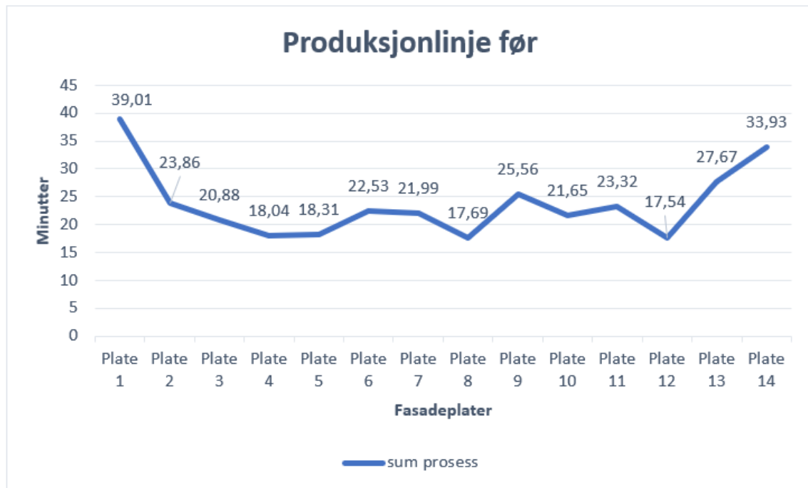
Figur 5-15 Produksjonstid per plate før innføring av prinsipper
