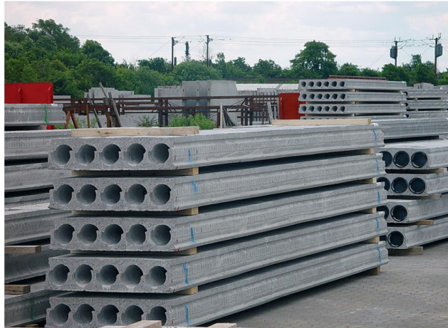
Figur 3.8: Hulldekker lagres i stabler som er adskilt med mellomlegg [57].
