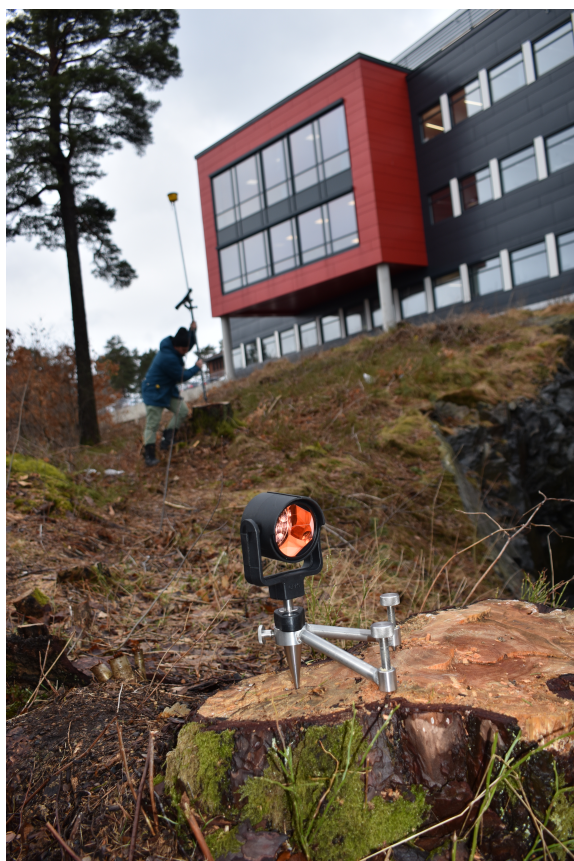
Figur 6.7: Eksempel på et utplassert prisme. Foto: Privat
