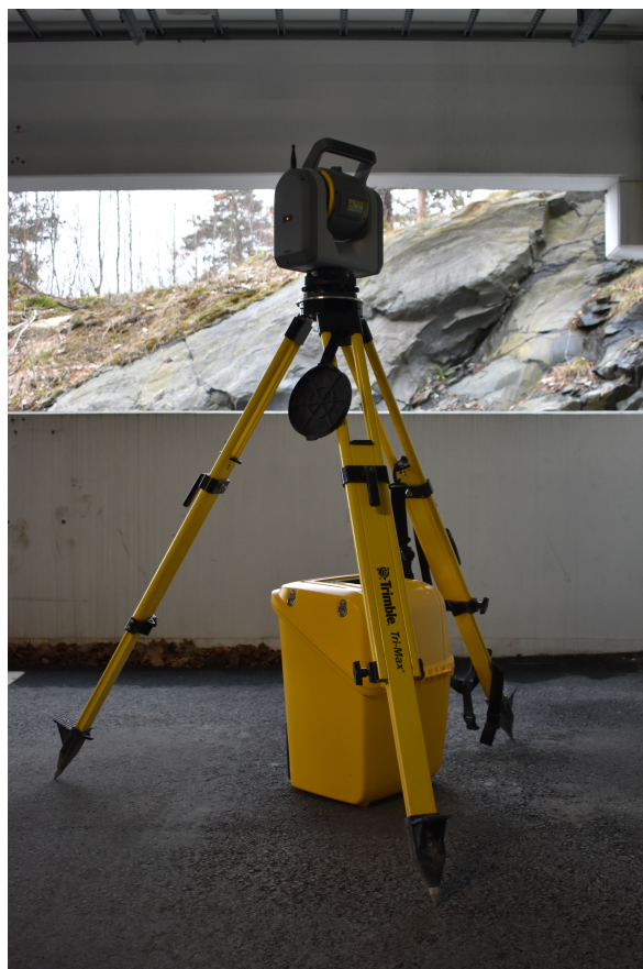
Figur 3.2: Trimble SX12 Scanning Total Station i aksjon ifm. det utførte eksperimentet. Foto: Privat
