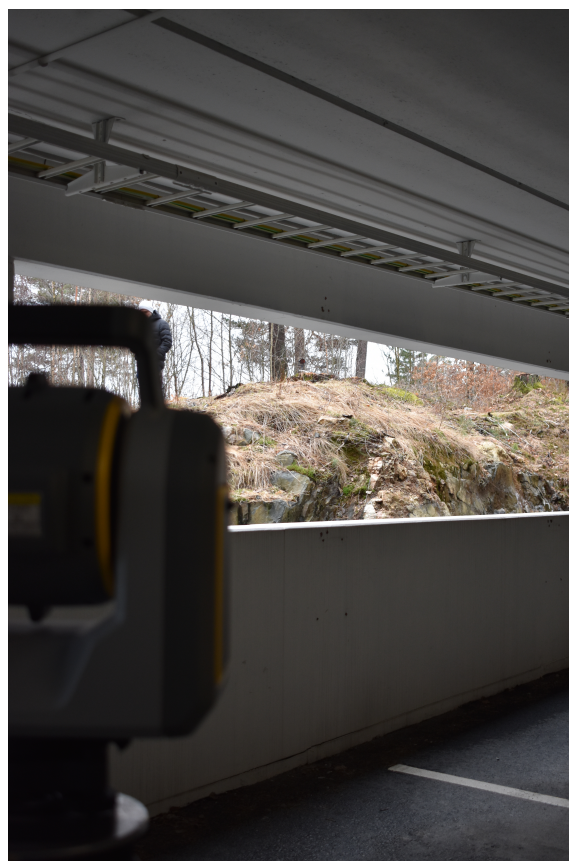
Figur 6.8: Trimble SX12 Scanning Total Station oppnår kontakt med et prisme. Foto: Privat
