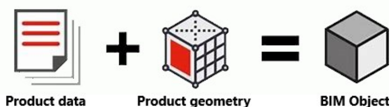
Figur 3.7: Prinsipiell skisse av et BIM-objekt [58]
