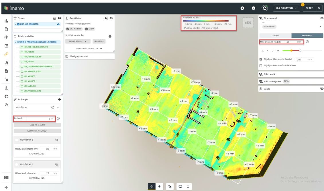
Figur 7.13: Skjermdump fra Imerso med varmekart samt gulvmål med maxverdier
