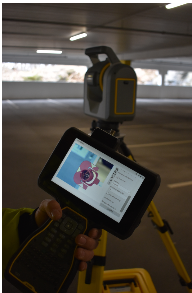
Figur 7.11: Trimble SX12 gjenkjenner og fokuserer på et prisme-referansepunkt. Foto: Privat
