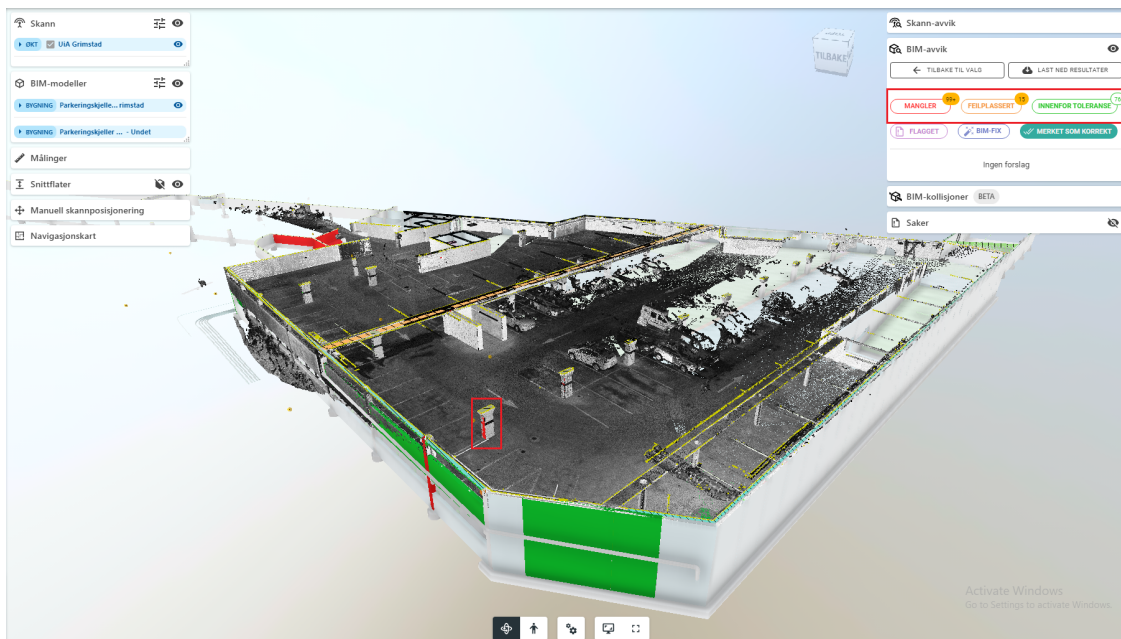
Figur 7.17: Skjermdump fra Imerso som viser BIM-avvik-analysen av hele fokusområdet med et par fremhevede momenter (røde bokser)
