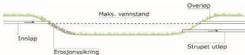
Fig. 3.22 – Åpent, tørt fordrøyningsbasseng [60]
