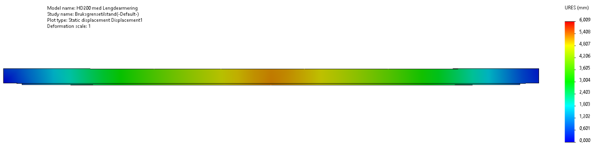
Figur 7.31 - Nedbøyningsresultat HD200 med lengdearmering(lineær modell)
