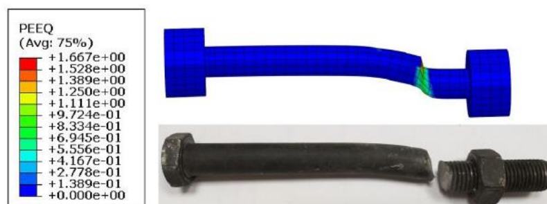
Figur 3.43 - Avskjæring av dybel, sammenligning FEM-analyse og forsøk [32]
