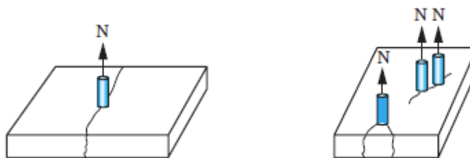
Figur 3.15 - Spaltebrudd i betong [11]
