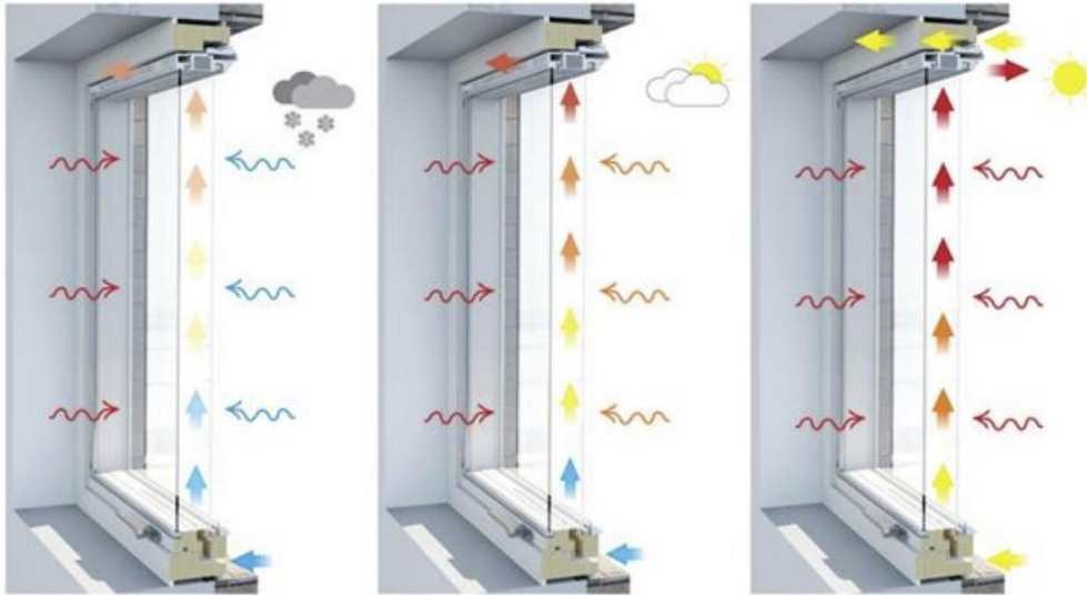
Figur 9: Prinsipiell fremstilling av ventilasjonsvinduet i 3 scenarioer; ved nøytralt klima, ved oppvarming og ved kjøling [37].
