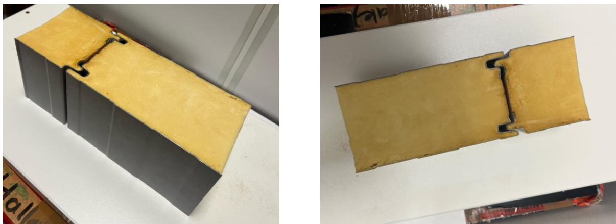
Figur 8: Sandwichelement med stålplater og pur isolasjon.
