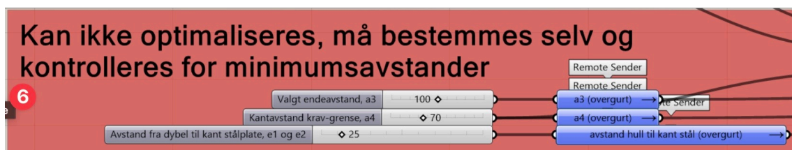
Figur 6.61: Valg av ende- og kant avstand fra dybel til tredel og stålplate
