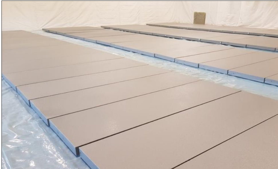
Figur 3.17 Foamrox-plater, her i fabrikk i Froland med nylagt membran. Foto: privat
