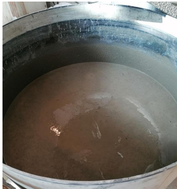
Figur 9.1.1 Feilblanding med betongseparasjon og høyt vanninnhold
