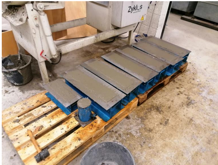
Figur 6.3.1 former fylt med betong
