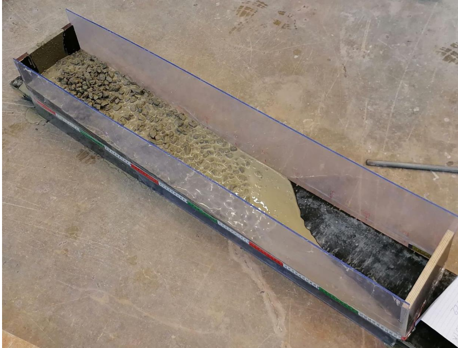
Figur 9.1.2 LCPC test av en feilblanding med tydelig separasjon
