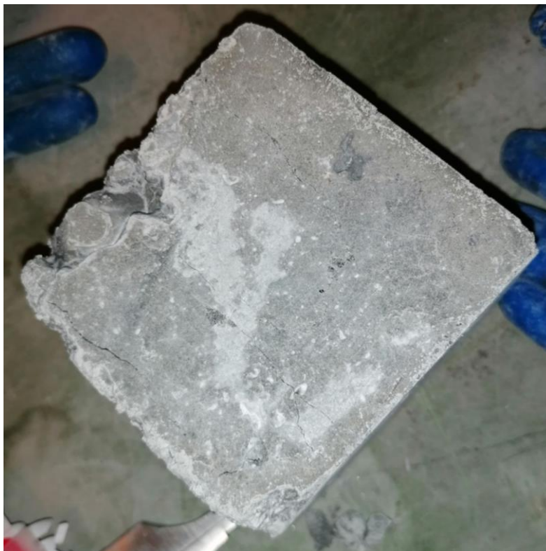
Figur 9.1.3 Ujevn overflate i en av terningene
