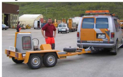
Figur 2 Utstyr som brukes til fallodsmålinger
