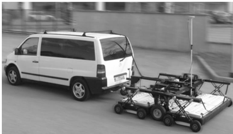
Figur 3-7 Array av typen Stream EM fra IDS, går i kilden under avansert utstyr, Kopiert fra: [26]
