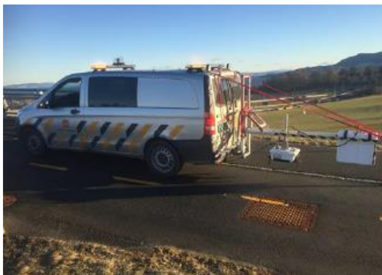
Figur 3-8 Luftkoplede georadar montert bakpå en av SVV sine målebiler. Kopiert fra [23, p. 308]
