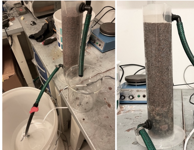
Figur 6-7. Oppsett av sandfiltrering (til høyre) og oppstrøms En-media filter med filtermedium sand/grus (til venstre).
