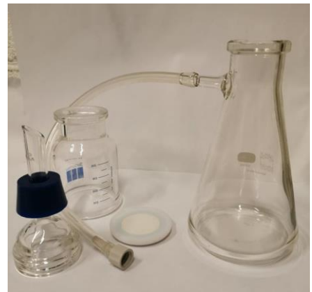
Figur 6. 1: Konisk kolbe med tilkoblet vakuumpump, filtreringskopp og filteropsats
