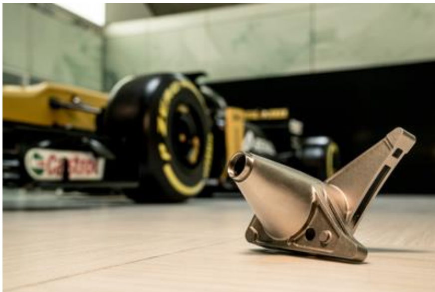
Figur 3-4: motordel produsert ved 3d-printing av metal for en formel 1 bil [26].
