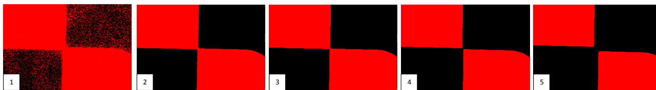
Figur 7.12: Hjørnene etter at Otsus metode er benyttet under segmentering ved de 5 forskjellige lysforholdene
