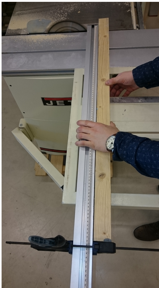
Figur 3.5: Sirkelsag og skrutvinger benyttet for å lage lengden på beina til plattformen så like som mulig
