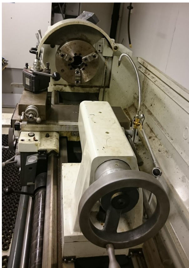
Figur 3.4: Dreiebenk benyttet for å lage utvendige gjenger på laserhylsene
