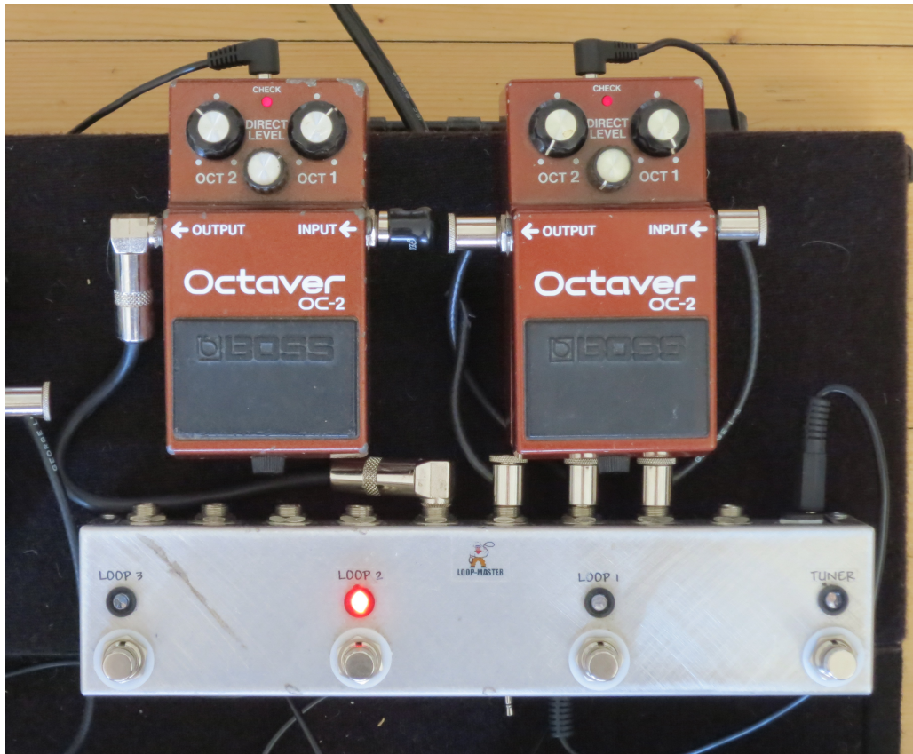
Figur 26. Boss OC-2 Octaver-pedalene koblet i Loop-Masterens effektsløyfer.
