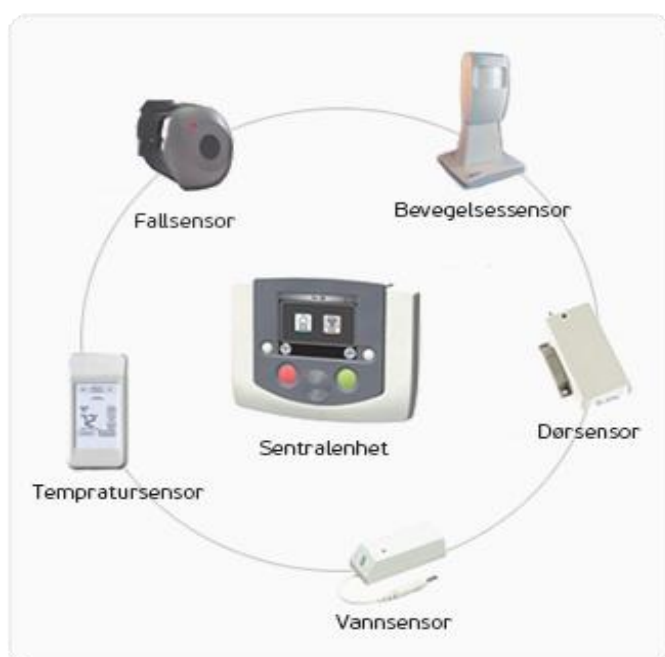
Figur 2. Eksempler på sensorer som sender alarmer til brukerens sentralenhet. (Visma, 2015)
