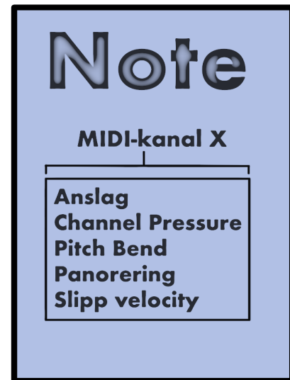
Figur 2-3 Hierarki for signaler i MPE-kompatible programvarer (egen illustrasjon)
