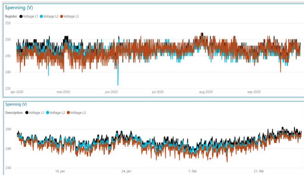
Figur 24: Spenningskarakteristikk ut fra trafostasjon i perioden 1. januar -1. mars 2021, samt sommerhalvåret 2020
