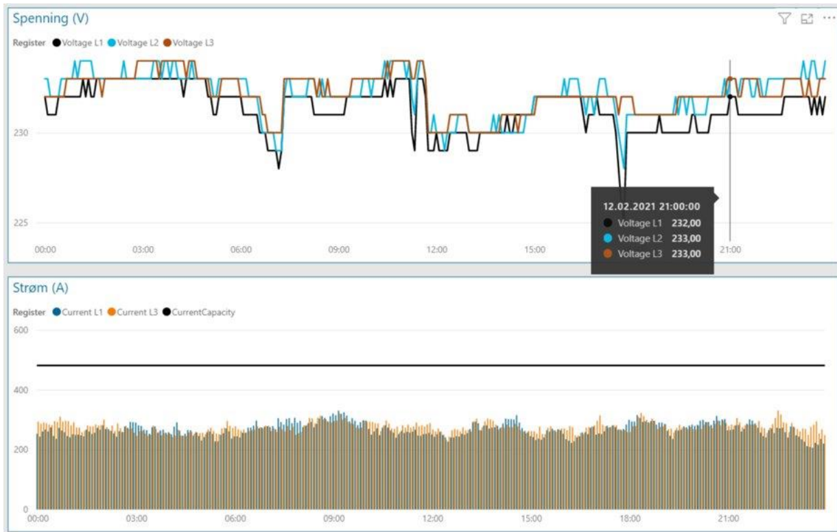
Figur ggg: Strøm- og spenningsverdier på nettstasjon, case 3
