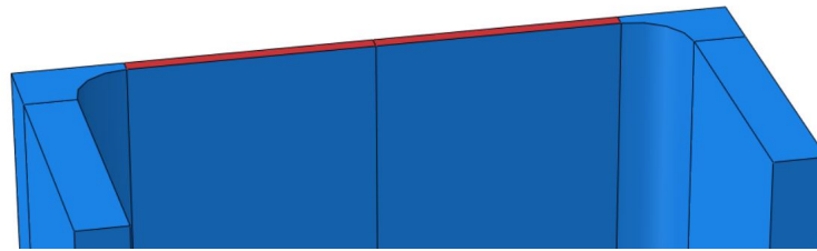
Figur 7.9: Flaten knyttet til referansepunktet RP-1 som påføres forskyvningen. Skjermdump fra ABAQUS.
