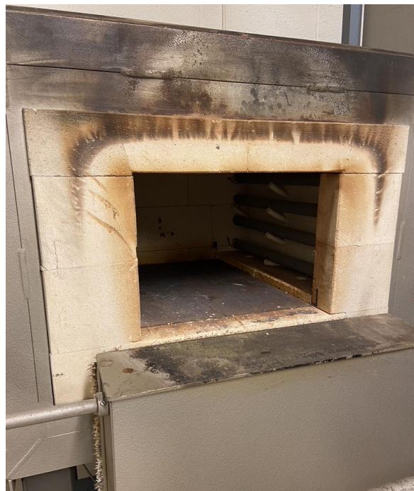
Figur 6.4: Ovn brukt til varmebehandling
