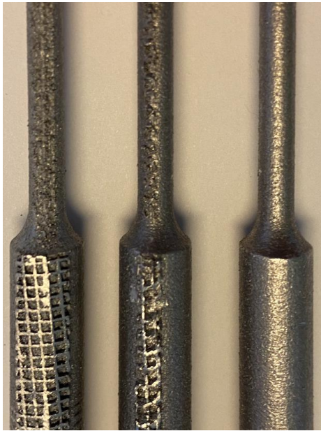
Figur 8.2: Overflate umaskinerte prøvestykker. Fra venstre: 0°, 45° og 90°
