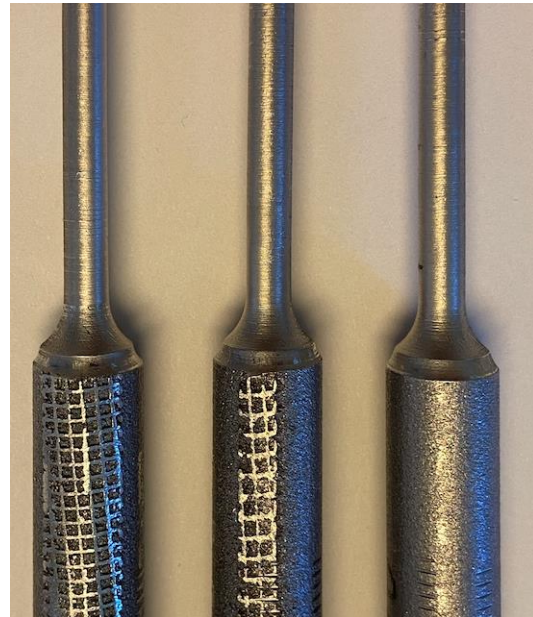
Figur 8.3: Overflate maskinerte prøvestykker. Fra venstre: 0°, 45°, 90°
