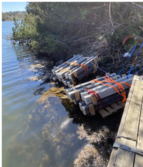
Figur 6.15: Plassering og forankring av testobjekter i skvalpesonen. Privat foto
