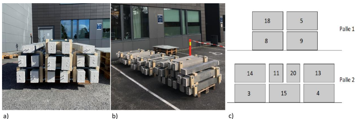
Figur 6.13: a) Plassering av testobjekter og klosser på sjøbunnsballen, b) ferdigstilte paller og c) plassering av testobjektene på pallene i skvalpesonen. Privat foto/figur
