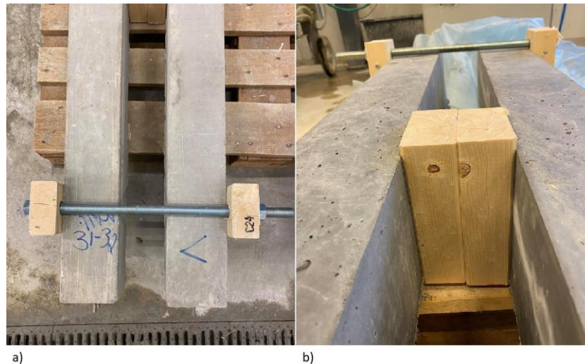
Figur 6.9: Plassering av a) tvingesystem og b) avstandsknast. Privat foto
