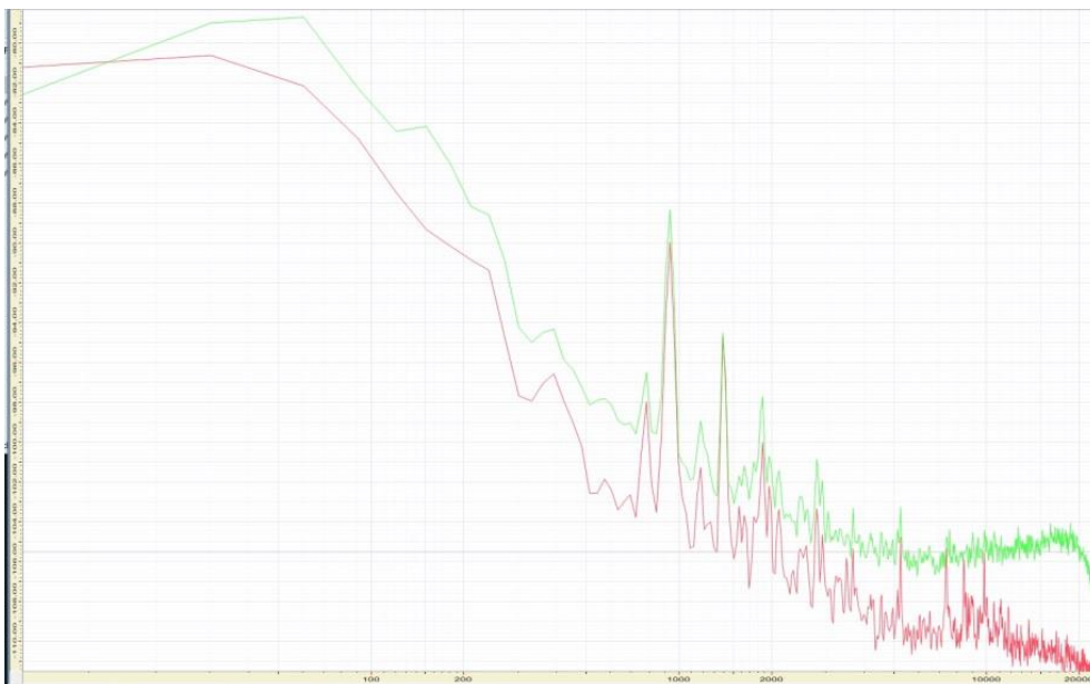
Figur 77 Støygulv. MC-master grønn og LP-master rød.
