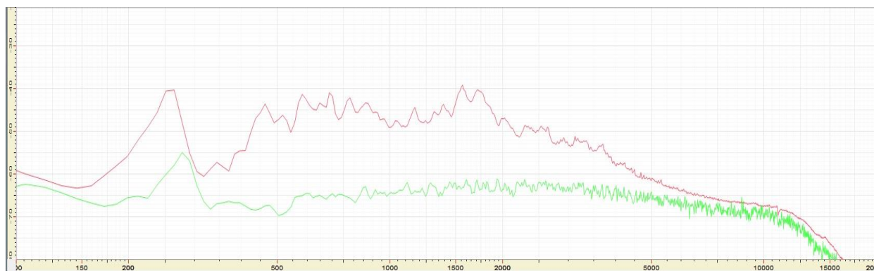
Figur 25 Signal mot støygulv. Gal etter Gutta. Støygulv målt ved senterstart.
