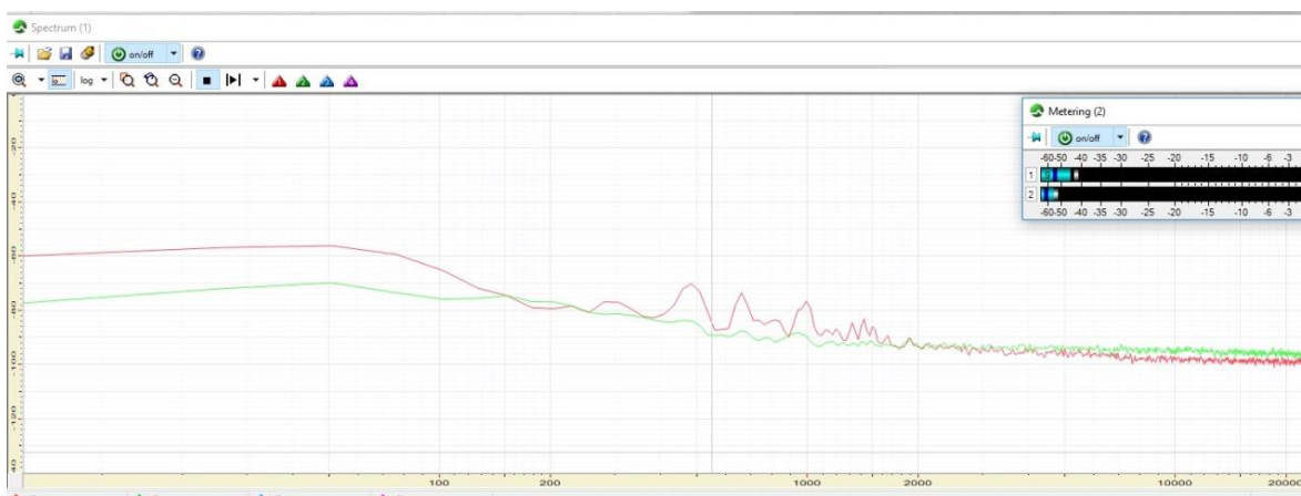
Figur 67 Støygulv. Grønn: original master 1. Rød: original master 2.
