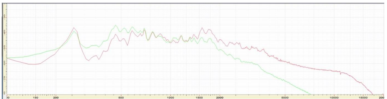
Figur 27 Signal. Rød: 90 rpm Pathé-plate. Grønn: 160 rpm støpt sylinder.
