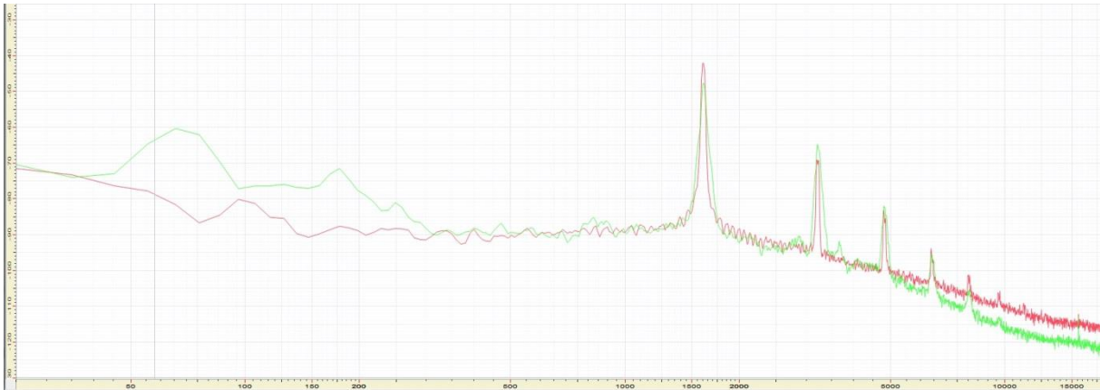
Figur 36 Sinus tone 1600hz. Original og pantografkopi.
