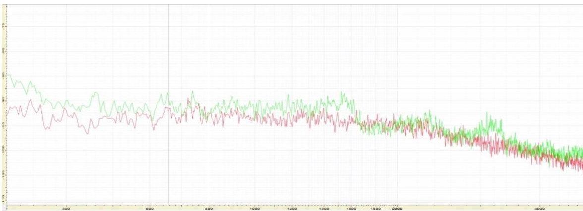
Figur 31 Støygulv. Original og pantografkopi.
