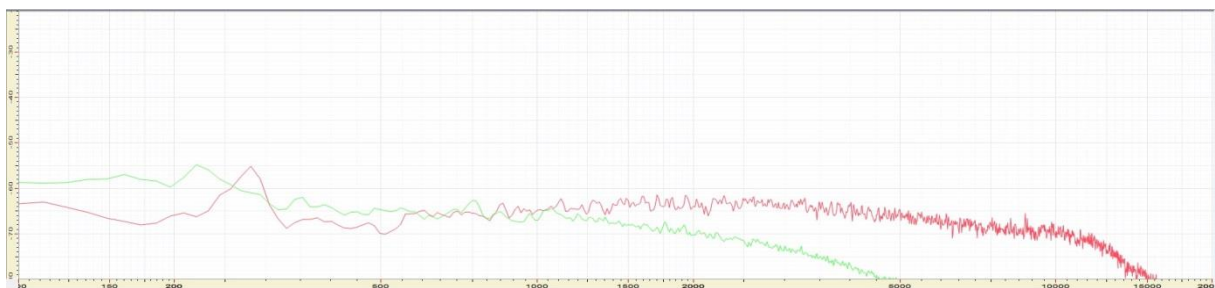
Figur 28 Støygulv. Rød: 80 rpm Pathé-plate. Grønn: 160 rpm støpt sylinder.
