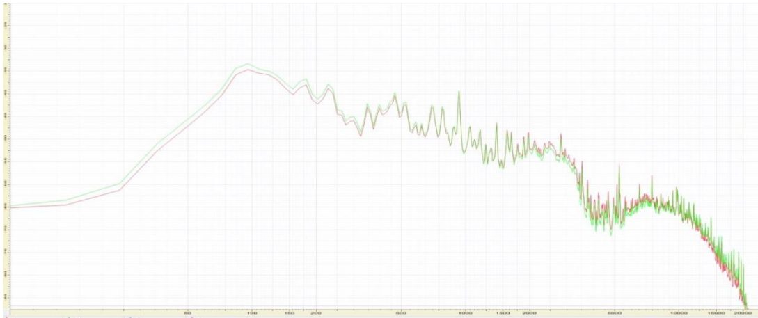
Figur 75 LP-master rød, og MC-master grønn. Gjennomsnittlig FFT.
