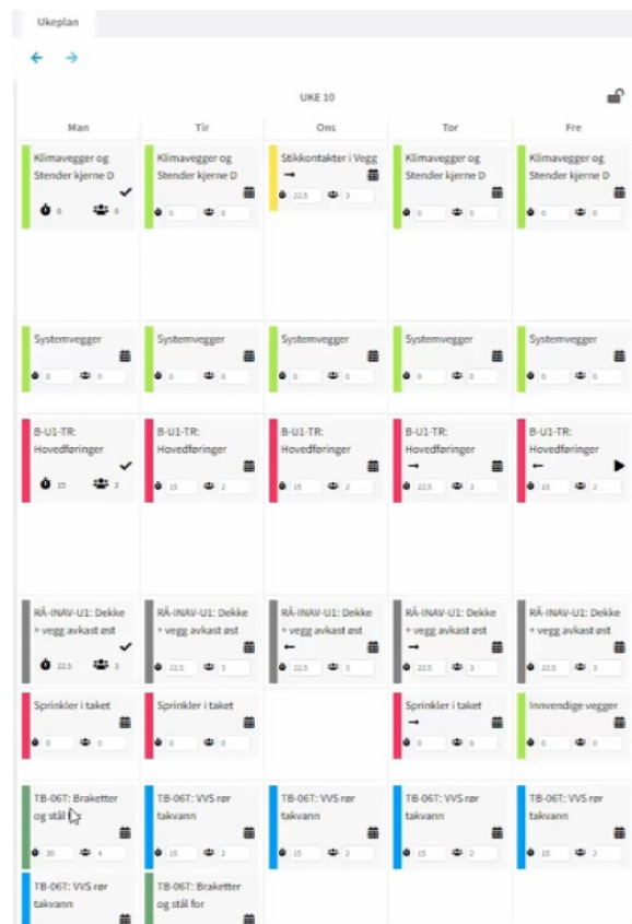
Figur 4.6: Illustrasjon av ulike jobbkort i ukeplan/BASmøte i iPG (Kruse Smith AS, 2019b)
