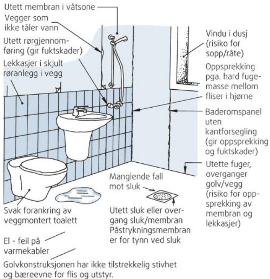
Figur 8-14 De vanligste feilene på våtrom [2]
