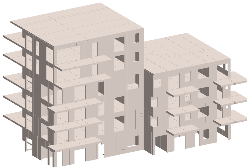
Figur 7.4-1 Bæresystem i massivtre [FEM-Design]
