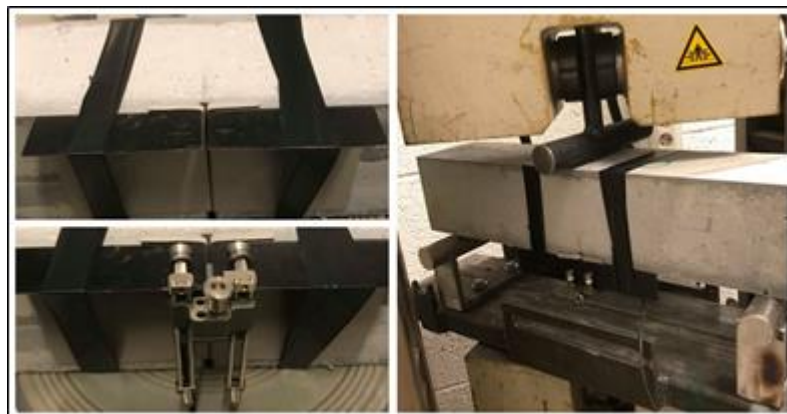
Figur 6-6 Bilde av ekstensometer, plater og hvordan dette festes i innskjæringen [Eget bilde]
