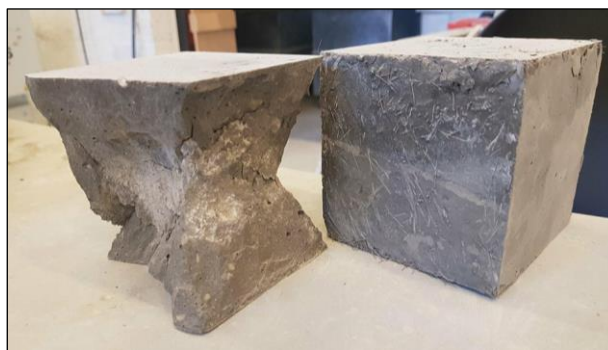
Figur 8-3 Bilde av betongterninger etter trykktesting (uten fiber til venstre, med fiber til høyre) [Eget bilde].
