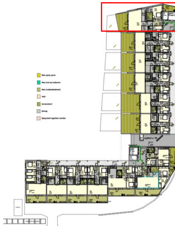
Figur 5.3 Etasjeplan for 1. etasje. Leilighet nr. 113 markert i rød firkant. Tegning fra BGM arkitekter
