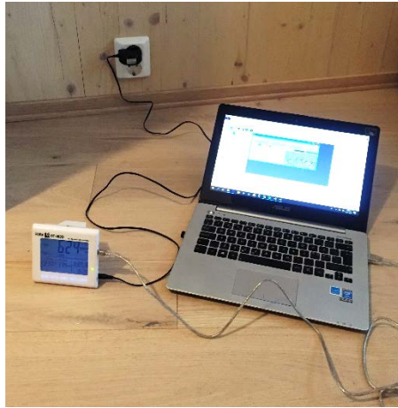
Figur 6.12. Uthenting av data fra loggeren til Multiple Datalogger
