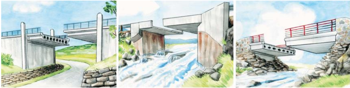
Figur 3.4: Illustrasjon av MOT- (venstre), PLA- (midt), og Super-I-brokonsepter (høyre) [26]
