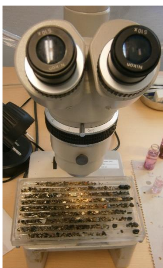
Figur 7: Grovsortering av prøvemateriale. Foto: Rita Næss
