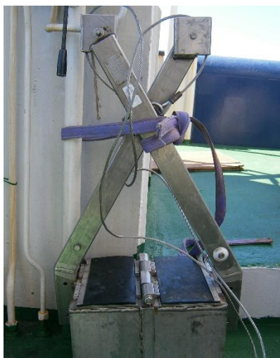
Figur 5: van Veen grabb brukt i prøvetakingen. Foto: Rita Næss
