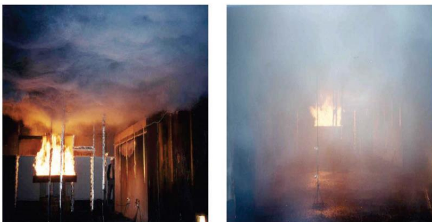
Figur 3.3. Røykforhold ved sprinkleraktivering
