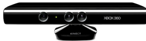
(d) Microsoft Kinect sensor.
