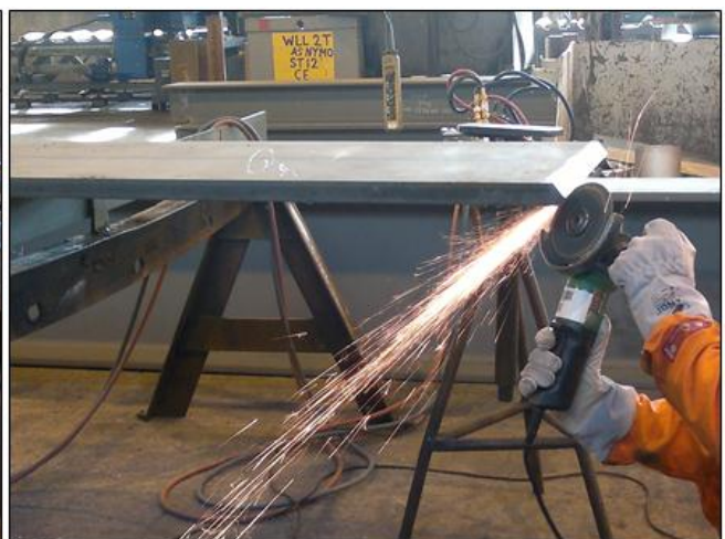
Figur 23: Fabrikasjon av plater; fugging. Fugging vil si at et lite stykke av platen fjernes, slik at den kan sveises i sammen med en annen plate. Det finnes ulike typer fuger, hvor navnene gir et inntrykk av hvordan fugen ser ut, f.eks V-fuge, I-fuge og K-fuge. Venstre: Fugebrenning med robot (K-fuge). Høyre: Sliping av plate etter fugebrenning.
