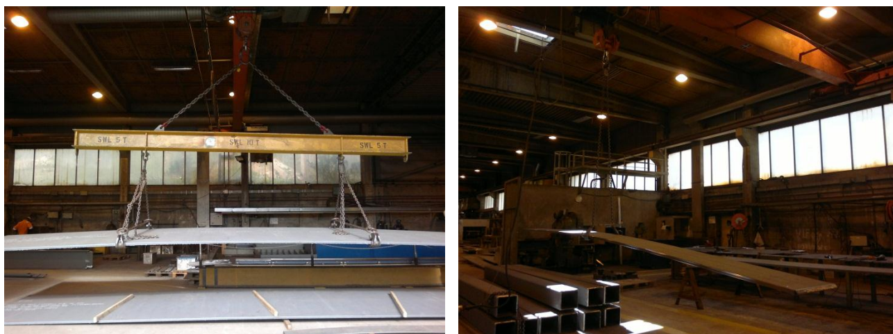
Figur 24: Krankapasitet kan være en flaskehals. Venstre: Løft av store plater med løfteåk, begrensninger i løftehøyde kan også være et problem. Høyre: Løft av mindre plater fra lagringsplass ved slipemaskin (venstre i bildet) til fugeområde (midt / høyre i bildet).
