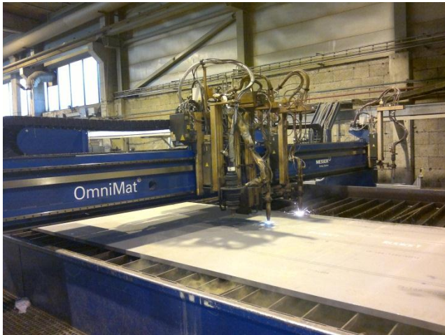
Figur 22: Venstre: Plasmabrenner som brenner ut og deler opp større plater til mindre etter arbeidstegninger fra ingeniøravdelingen. Høyre: Et av arbeidsområdene for bearbeiding av stål, dette er fra fugeområdet.
