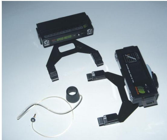
Figur 8 Sender og mottakerenhet for måling av køllehodehastighet. Gummi-peg med strikk til å sette golfballen på.
