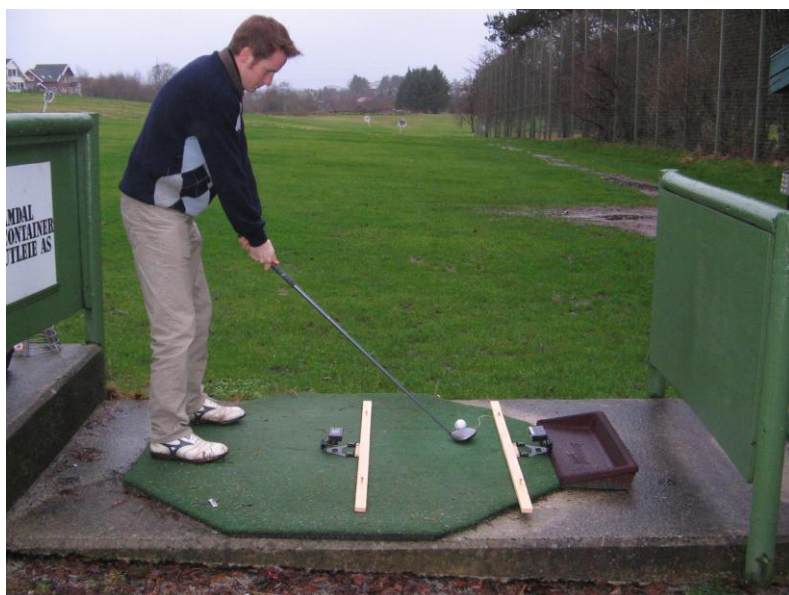
Figur 9 Oppsett ved måling av køllehodehastighet. Her er måleutstyret montert på en utendørs utslagsmatte.
