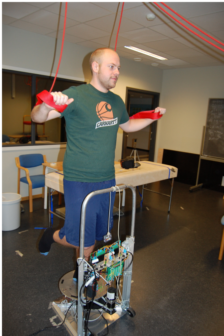
Figur 26. Viser løkkene som testpersonen kunne støtte seg på i tilfelle fall og utgangsposisjon under testen, Maks dynamisk balansetest.
