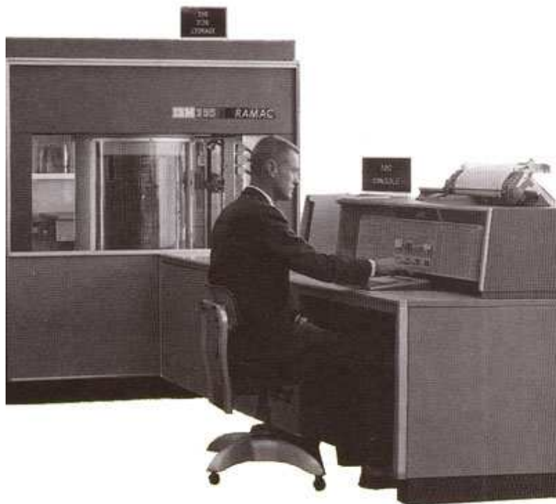
Første harddisk fra 1956 – IBM 305 RAMAC
