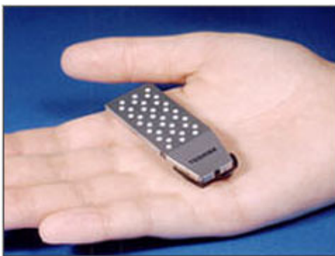
Figur 17 Toshibas metanolbrenselcelle med energi utbytte på 100 mW [16]
