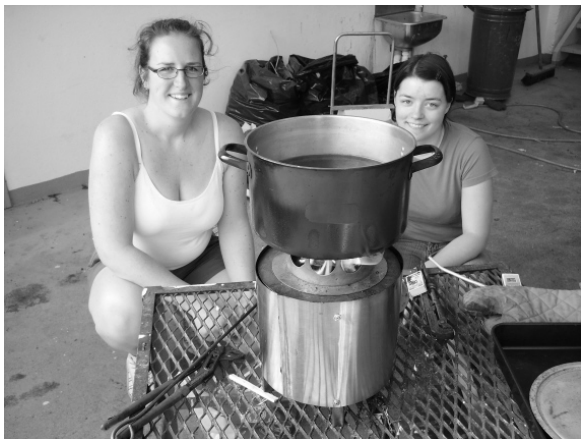
Figur 1: Under forbrændingsøvelsen testes ovnens nyttevirkning og effekt ved vandopvarmning.
