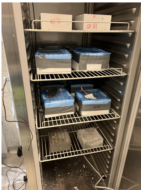
Figur 6.13: Frysenskap med betongprøver.
