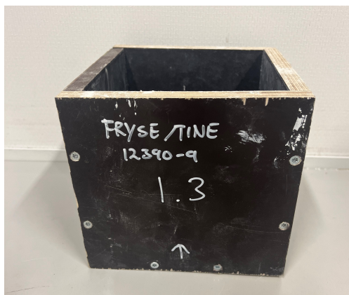
Figur 6.4: Egenprodusert støpeform 150 x 150 x 150 mm.
