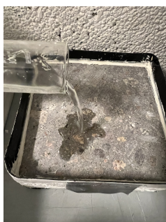
(a) 70 ml ionebyttet vann helles på prøven.
