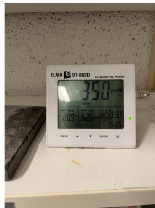
(b) Måler til temperatur, luftfuktighet og \text{CO}_2 .
