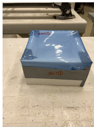
(b) Ferdig isolert betongprøve
