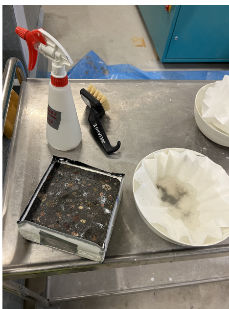
Figur 6.14: Avskalling på grå betongrøve fra frysenskap
