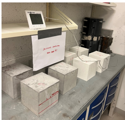
(a) Betongterninger i «herdekammer».
