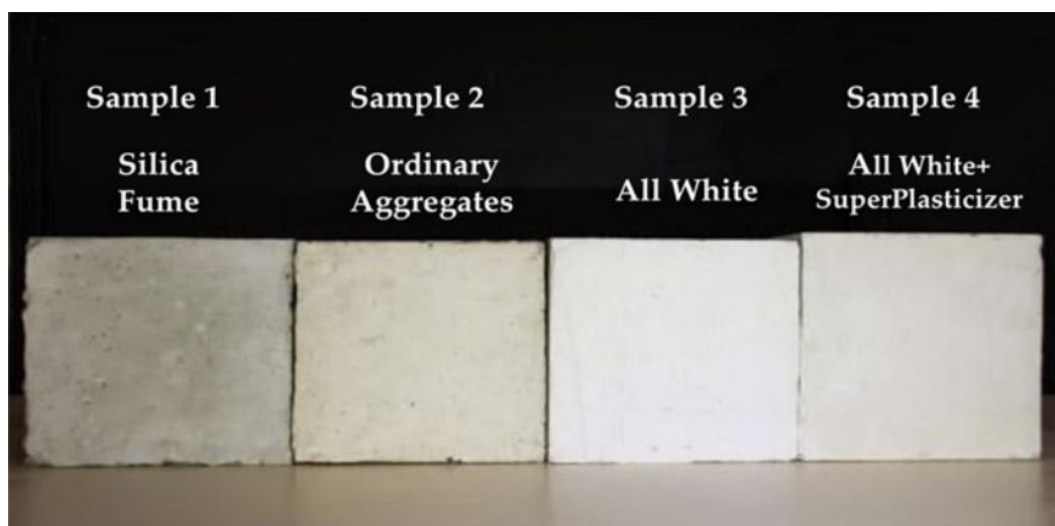
Figur 7.6: Sammenligning av hvit betong med ulike tilsetninger[17]
