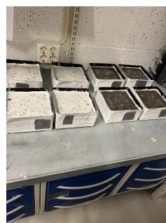
(b) Ionebyttet vann på betongflaten
