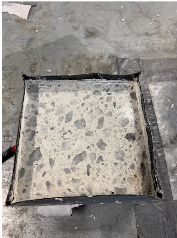
Figur 7.11: Overflaten til den hvite betongen etter 56-sykluser.
