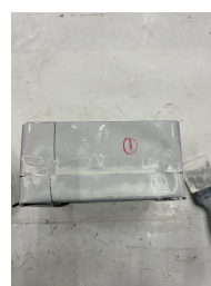
(b) Siden av beongprøve med butyltape.
