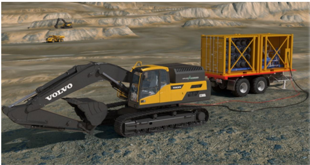
Figur 4.11: Hydrogendrevet Volvo EC300EL under fylling av portabel hydrogenbank.
