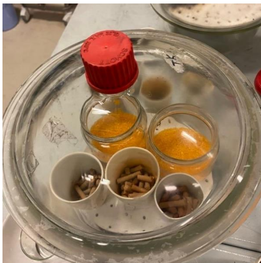
Figur 7: Vakuundesikator med silicagele
