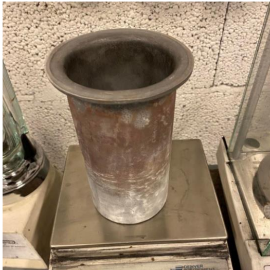
Figur 6: Reaktor som benyttes til pyrolysing.
