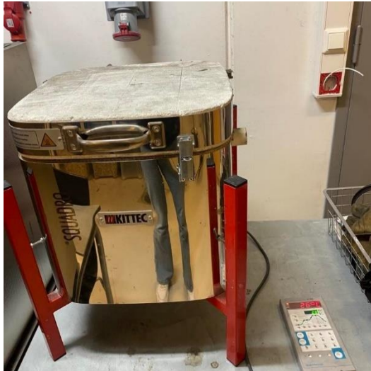
Figur 5: Kittec SQ 11 Elektrisk ovn benyttet til pyrolysing.
