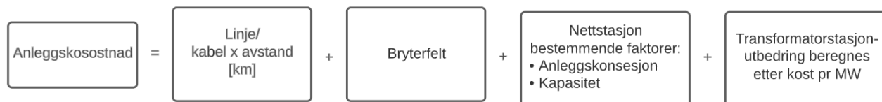
Figur 5.1: Den økonomiske modellen fremstilt som et forenklet blokkdiagram for enkel forståelse av hvilke elementer som inngår i modellen
