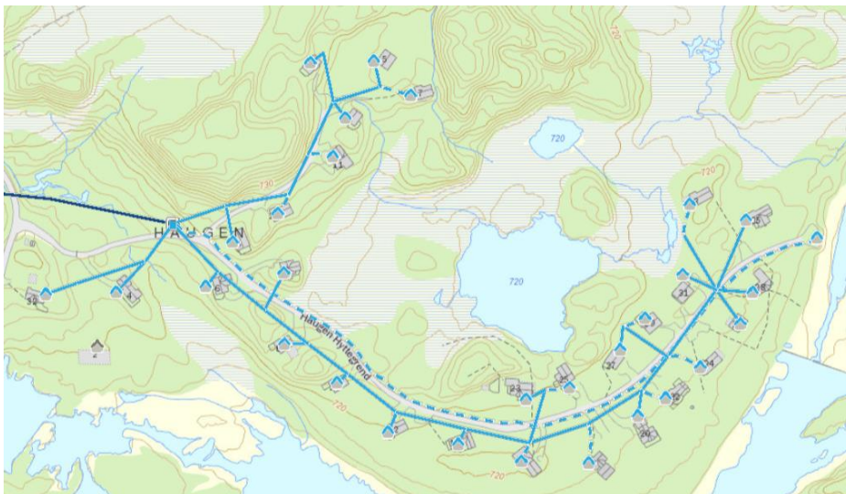
Figur 2 Transformator-krets med 30 tilkoblede sluttkunder.
