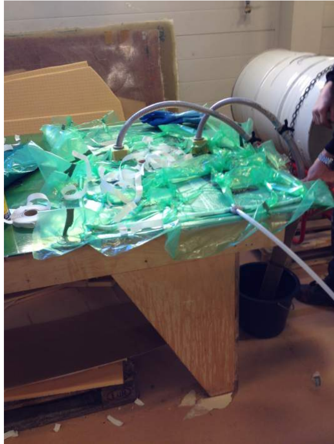
Figur 4.2: Platen under vakuum og resininjering
