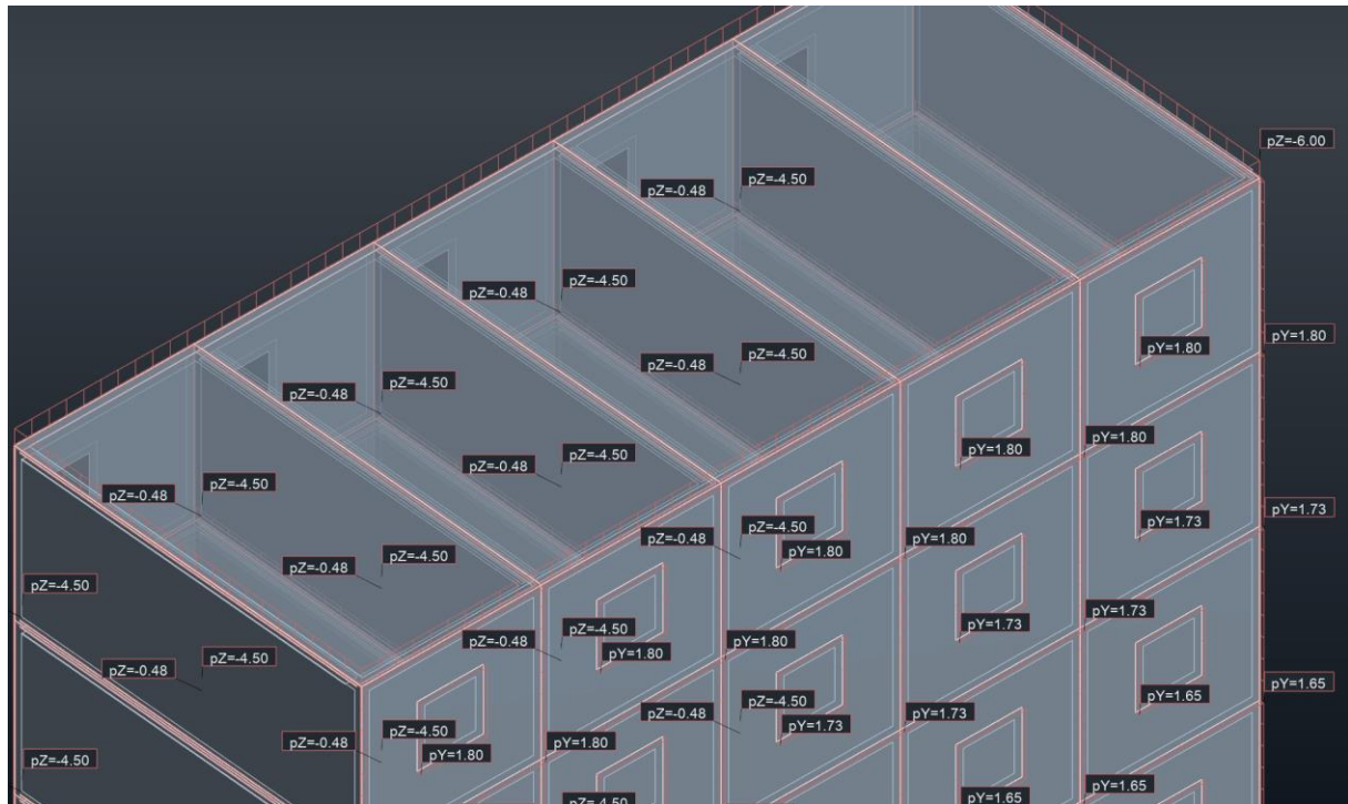
Figur 6-16 Lastkombinasjon COMB 3: vertikal + vind Y, utsnitt. [31]
