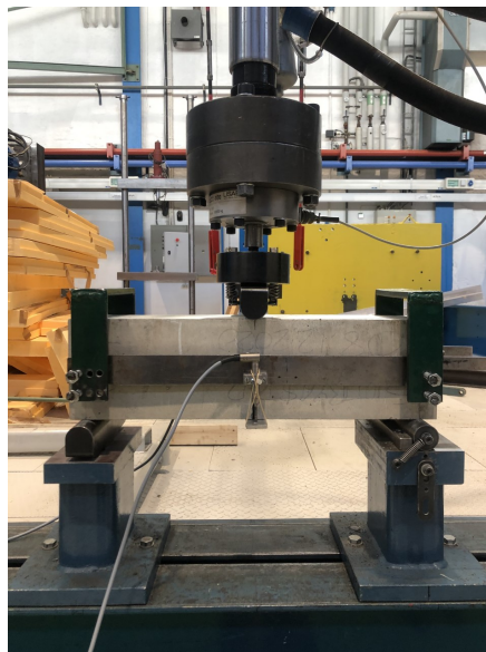
Figur 6.9: Bjelketest i en servohydraulisk prøvingsmaskin. [1]
