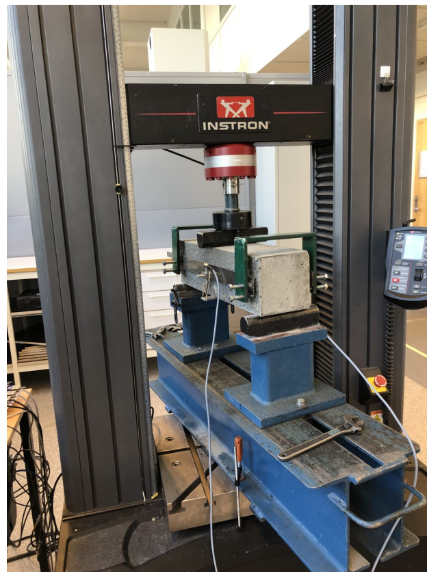
Figur 6.10: Bjelketest i en motormekanisk prøvingsmaskin. [1]
