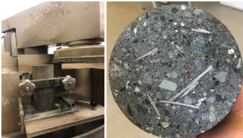
(a) Plansliping av sylinder.
