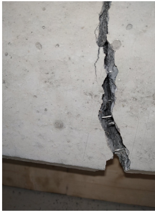
Figur 7.40: Basaltfiber som ble dratt ut av betongen. [6]
