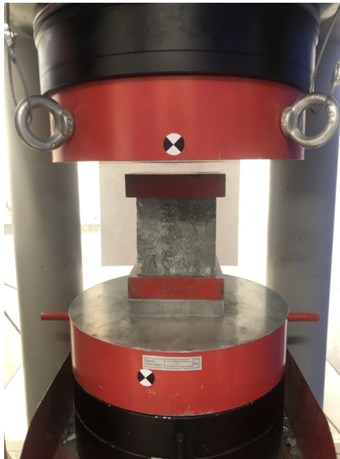
Figur 6.1: Trykktest av terning i prøvingsmaskinen. [1]
