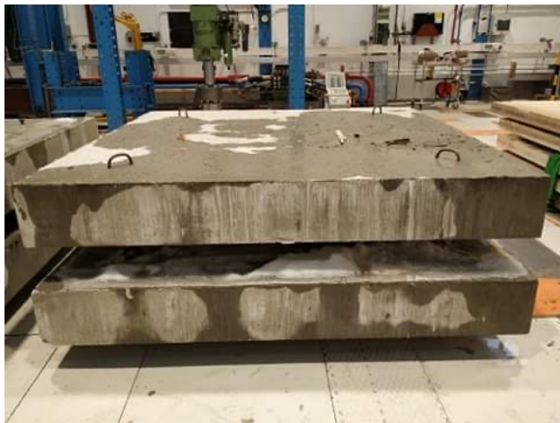
(a) To av fundamentene som ble testet.
