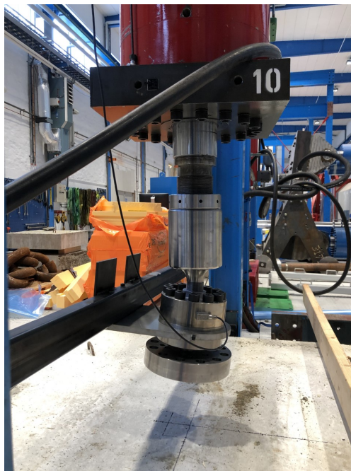
Figur 6.19: Bilde av lastcellen etter skade fra testingen. [1]
