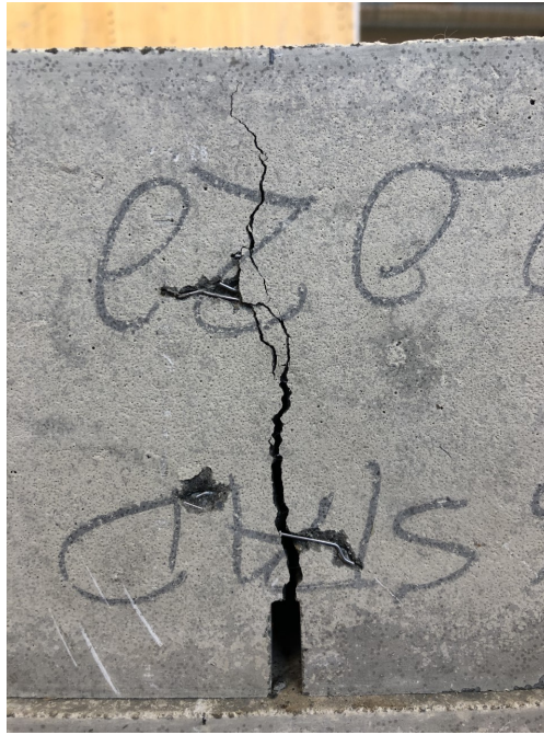
Figur 8.3: Stålfiberarmert bjelke etter trepunkts bøyetest. [1]
