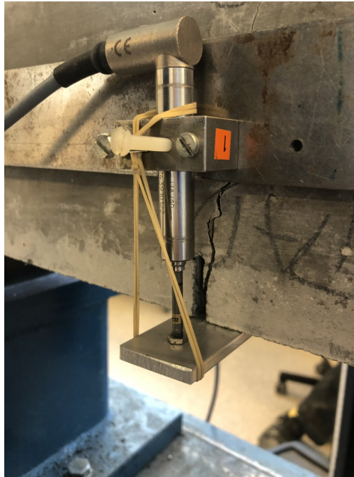
Figur 8.2: Måling av deformasjon under sagsporet. [1]
