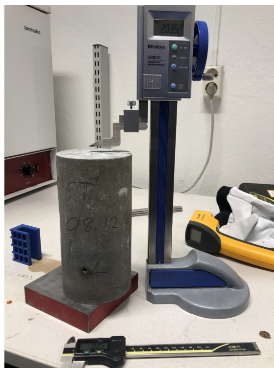
Figur 6.3: Måling av sylinder etter plansliping. [1]
