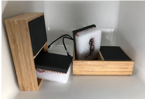
Figur 4.4 To digitale trommepadder som viser deler av den implementerte elektronikken, Kristiansand, 4. Juni 2020
