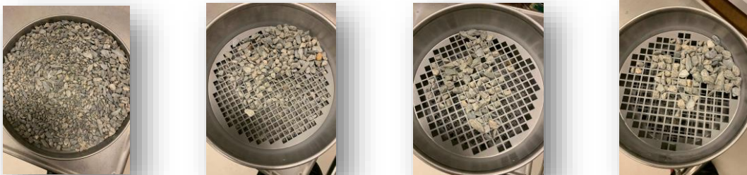
Figur 6-4 Siktesett med alle delfraksjonene etter utført sikting [29].
