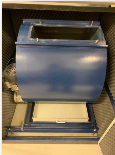
Figur 6-2 Los Angeles-test maskin med innebygd telleverk [29]
