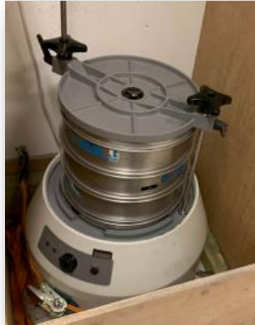
Figur 6-3 Siktesett for sikting til LA-fraksjon 10/14 [29].
