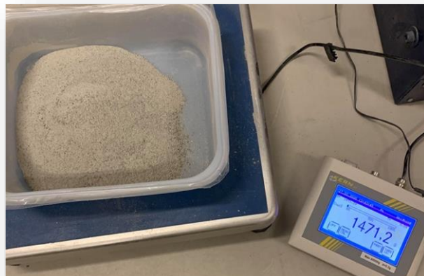
Figur 6-6 Prøvematerialet etter LA-test som er mindre enn 1,6 mm [29].
