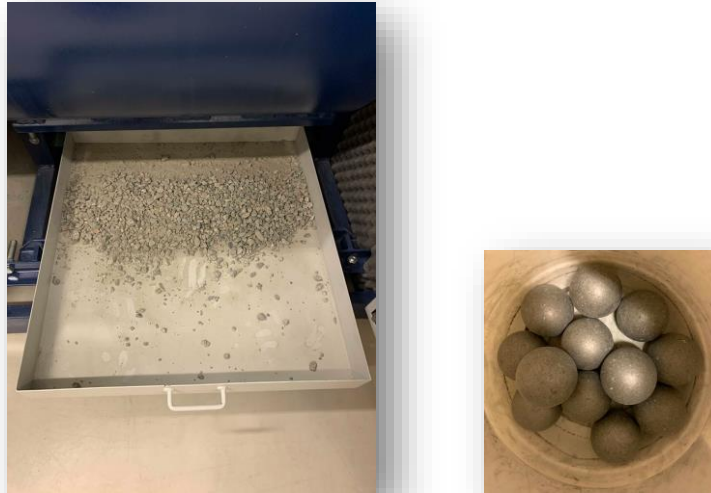
Figur 6-5 Stålbakke under LA-maskinen og stålkulene [29].
