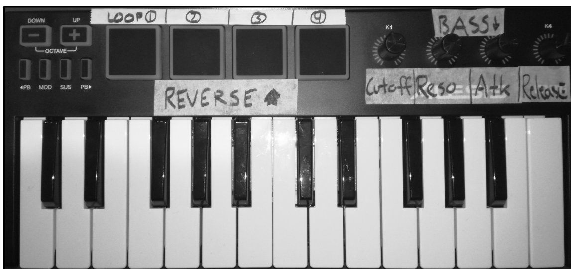
Figur 3.2: Alesis V Mini. Trigger basslyd, kontrollerer loop-reversing og utvalde synth-parameter
