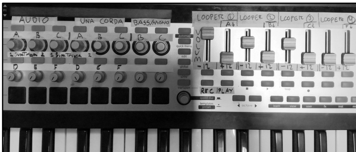
Figur 3.1: Novation SL MK II. Trigger pianosample, kontrollerer sends på dei tre spora, SupaTrigga og loop record/volum/start/stop/oktivering/busnivå
