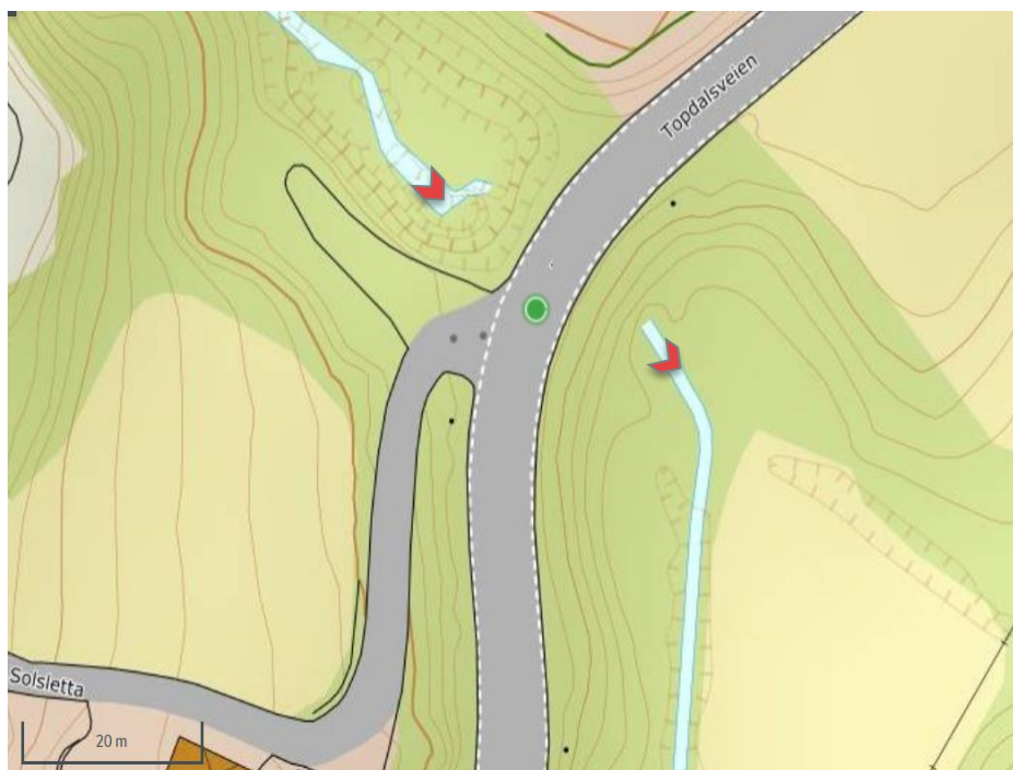
Figur 10: Eksempel på potensielt vandringshinder. Bekk (Østrebekk) ligger i kulvert under veg. Røde piler oppstrøms og nedstrøms for hinderet viser retning havet. Vannprøvene ble tatt ved området pilene viser, 0-100 m langs elva fra kulverten. Detaljer finnes i vedlegg. Kart: Vegkart, Statens vegvesen
